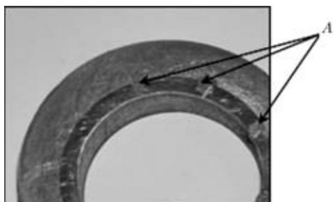
Рис. 4. Макрошлиф сварного соединения; А — места отверстий, заполненных алюминием
