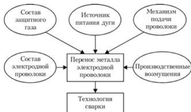
Рис. 2. Схема основных параметров сварочного процесса, воздействующих на перенос металла электрода
