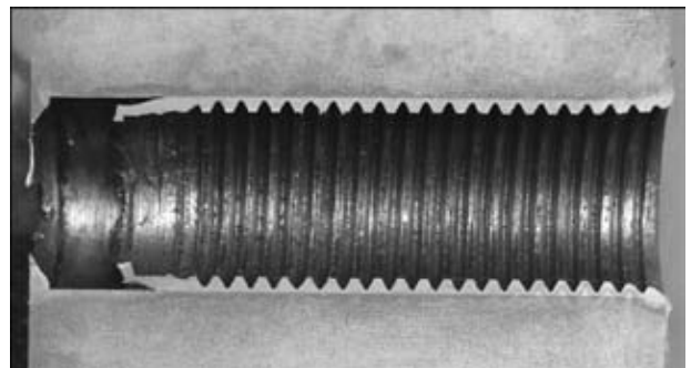
Рис. 5. Макрошлиф восстановленного резьбового отверстия
