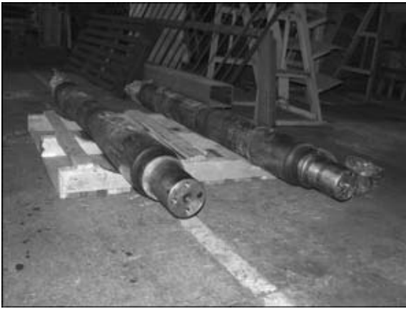
Рис. 8. Общий вид отремонтированных осей РУ1-Ш
