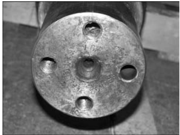
Рис. 9. Восстановленный под нарезку резьбы канал
