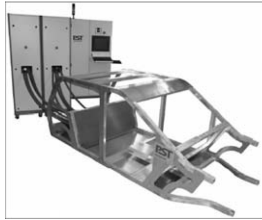
Рис. 3. Первая в мире легковесная рама корпуса автомобиля из разнородных металлов, изготовленная полностью с помощью МИС
