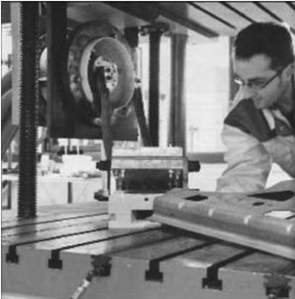
Рис. 12. Магнитно-импульсная резка (пробивка отверстий) деталей автомобильного назначения в Fraunhofer IWU с использованием элементов оборудования PST [28]
