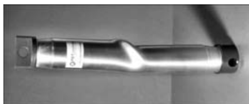
Рис. 10. Образец трансмиссионного вала (алюминий–сталь), сваренного МИС, после успешных испытаний на прочность при скручивании
