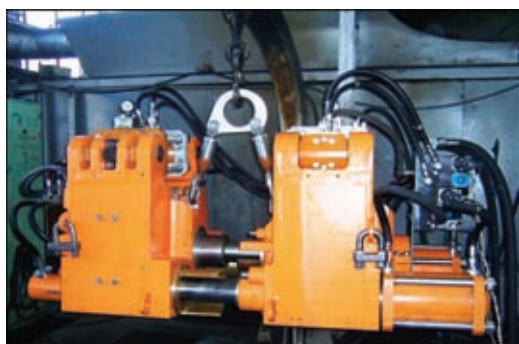
Рис. 8. Машина K930 для сварки рельсов с натяжением бесконечной длины
