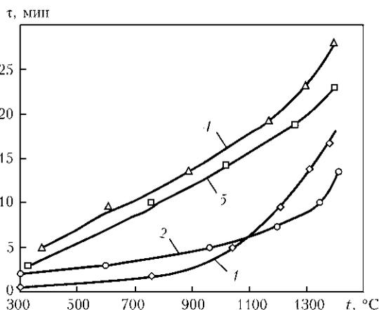
Рис. 3. Интенсивность электрошлакового нагрева поверхности штампов размерами 210×210×50 мм. Удельная мощность —  $150 \cdot 10^4$  Вт/м<sup>2</sup>, напряжение — 35 В
