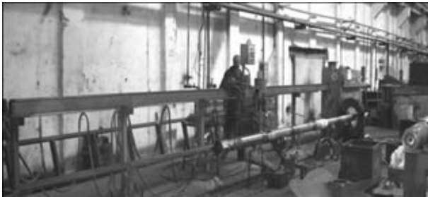
Рис. 1. Наплавочная установка на базе машины RM 461E
