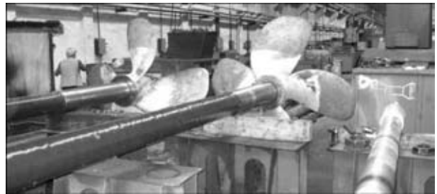
Рис. 5. Гребной вал в сборе с винтом
