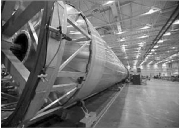
Рис. 6. Резервуар ракеты-носителя «Falcon 9» из алюминиево-литиевого сплава (предприятие «SpaceX»), продольные и круговые швы которого сделаны с помощью СТП. При этом полностью исключается формирование водородных пузырей (режим доступа: [http://en.wikipedia.org/wiki/File:SpaceX\\_factory\\_Falcon\\_9\\_booster\\_tank.jpg](http://en.wikipedia.org/wiki/File:SpaceX_factory_Falcon_9_booster_tank.jpg))
