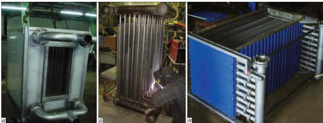
Рис. 4. Экономайзеры-утилизаторы разной мощности: а — мощность 0,2 МВт для котла КПВИ 3000; б — мощность 0,68 МВт для котла газопоршневой электроустановки FG WILSON PG 1259 В; в — мощность 1,2 МВт для котла ПТВМ-30М
