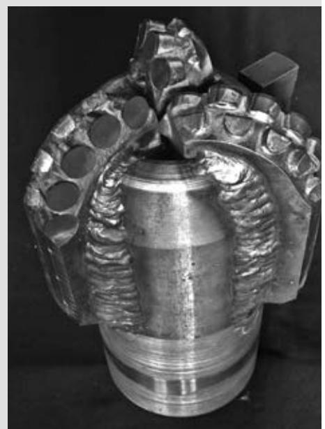
Долото с алмазно-твёрдосплавными резцами для подземного бурения
