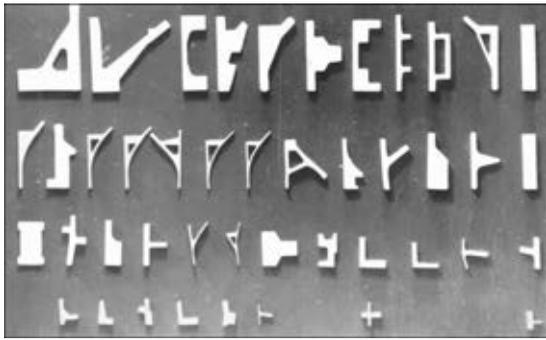
Рис. 1. Примеры профилей из алюминиевых сплавов, свариваемых КССО
