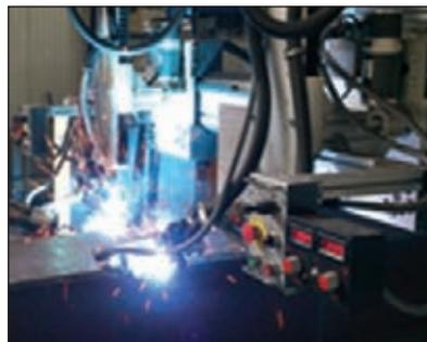
Рис. 3. Сварочная головка для сварки в защитном газе
