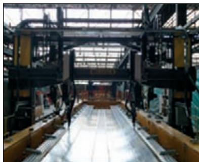
Рис. 1. Автоматический портал для сварки крыши вагона
