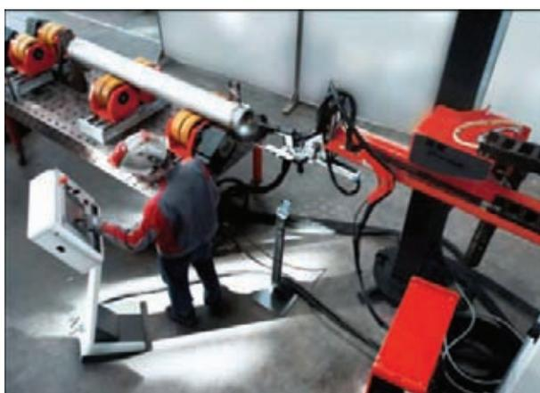
Коррозионностойкая наплавка поясков шириной 90–150 мм в месте стыка плакированных труб (в т. ч. *BU·BI*; 6–15 м) диаметром 125–460 мм
