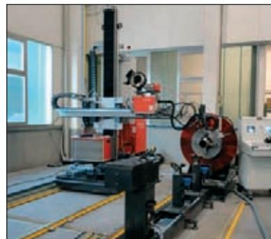
Рис. 9. Автоматическая колонна для сварки тел вращения
