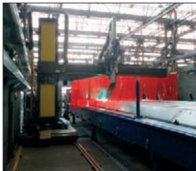
Рис. 10. Автоматическая колонна для сварки крыши вагона
