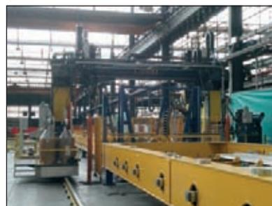
Рис. 8. Портал для сварки тележки вагона
