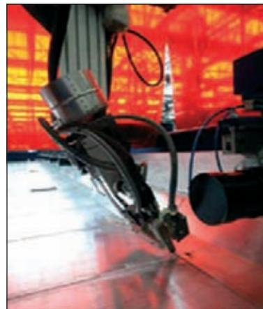
Рис. 5. Лазерная система слежения
