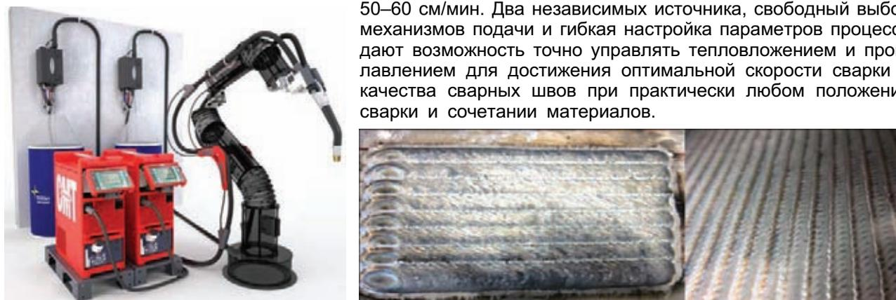
**FCW – «Valve welding»** — автоматизированная установка для кольцевой сварки запорной арматуры.
