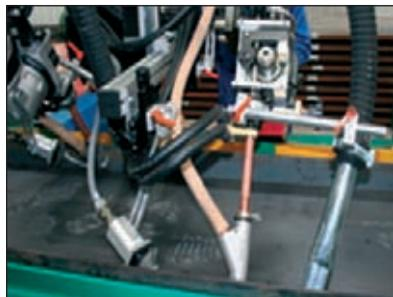
Рис. 2. Сварочная головка под слоем флюса с системой рециркуляции
