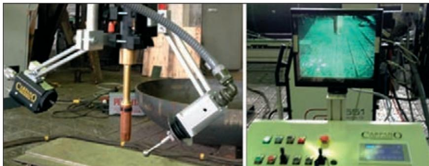
Рис. 6. Система видеонаблюдения для сварки в защитном газе
