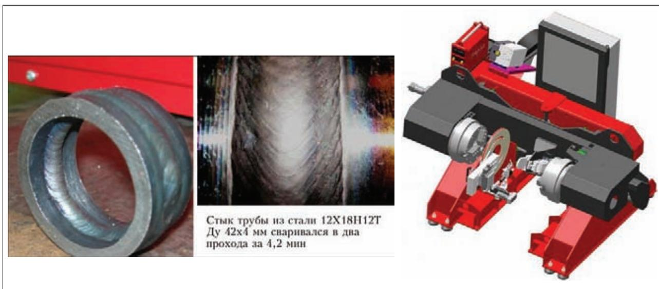
Стык трубы из стали 12Х18Н12Т Ду 42х4 мм сваривался в два прохода за 4,2 мин
