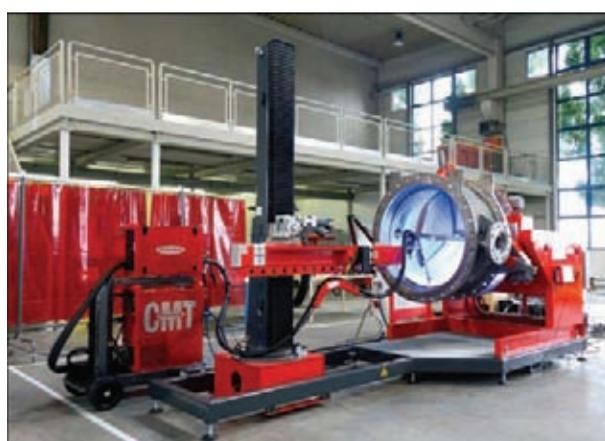
Освоена наплавка уплотнительного выступа в корпусе крана Ду 300–1200 из чугуна типа ВЧ 40 без предварительного и сопутствующего подогрева проволокой Св-08Х20Н9Г7Т и в комбинации с проволокой Св-07Х25Н13
