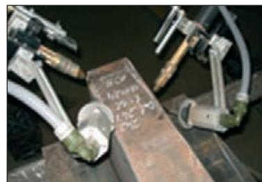
Рис. 4. Тактильная система слежения
