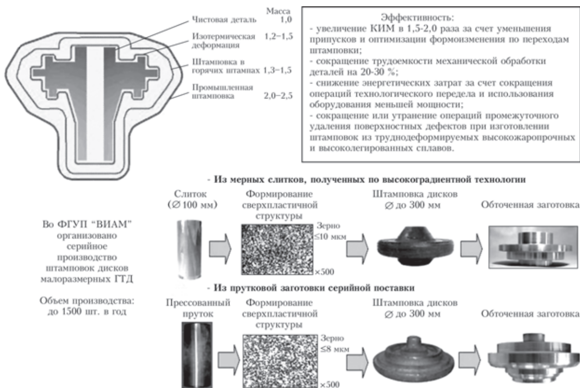
Рис. 8. Изотермическая штамповка жаропрочных дисковых сплавов на воздухе для малоразмерных ГТД
