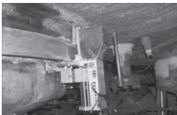
Рис. 8. Система АВГУР 5.2 для автоматизированного ультразвукового контроля гибов трубопроводов первого контура реактора ВВР-1000
