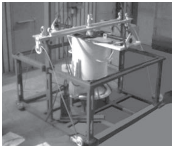
Рис. 20. Модуль для соединения разрушенных труб скважин
