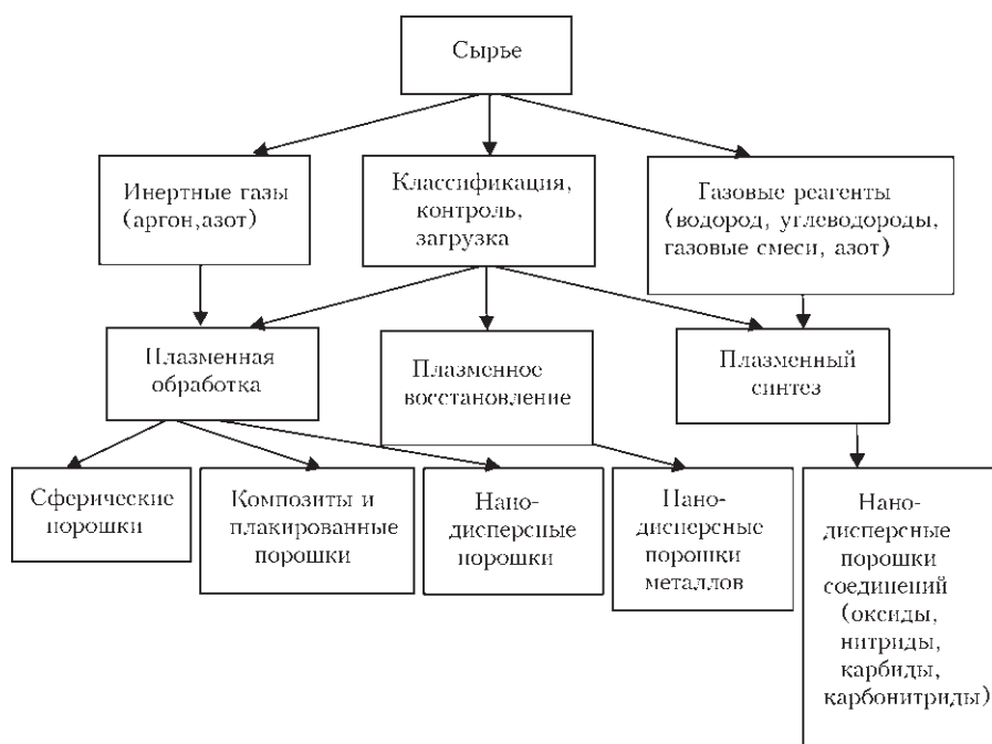
Рис. 4. Схема плазменной технологии производства порошков
