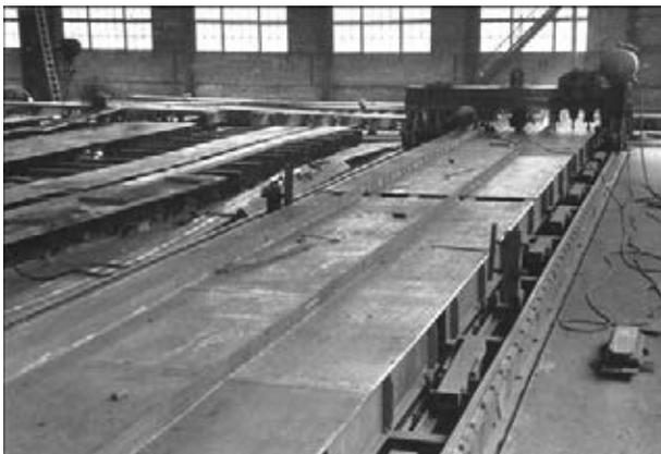
Рис. 3. Процесс сборки ферм в кондукторе
