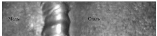
Рис. 8. Бездефектное сварное соединение меди со сталью
