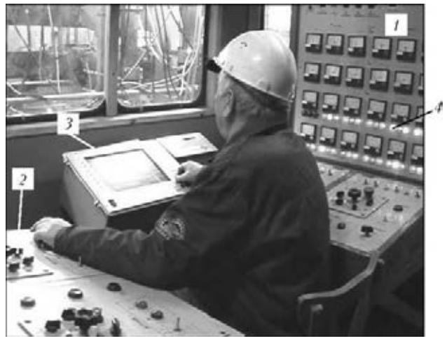
Рис. 3. Центральная кабина управления агрегатами установки: 1, 2 — соответственно пульты управления правым и левым блоком; 3 — промышленный компьютер PC670 системы мониторинга режимов сварки; 4 — сигнальные лампочки контроля движения сварочных проволок
