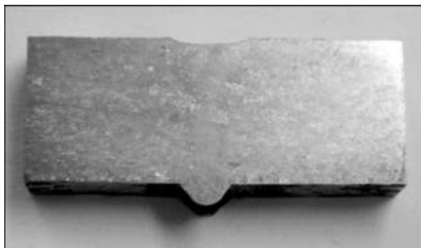
Рис. 4. Макрошлиф сварного соединения сплава 1, выполненный ЭЛС с предварительным подогревом 200 °С
