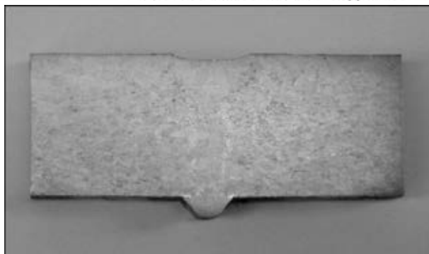
Рис. 5. Макрошлиф сварного соединения сплава 1, выполненный ЭЛС с предварительным подогревом 200 °С и последующей ЛТО
