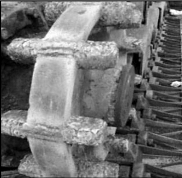
Рис. 4. Внешний вид восстановленной ведущей звездочки крана КС8165
