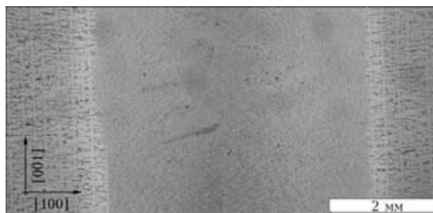
Рис. 1. Микроструктура металла шва сварного соединения сплава ЖС26 с симметричной кристаллографической ориентацией
