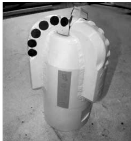
Рис. 4. Внешний вид лопасти долота с впаянными АТР
