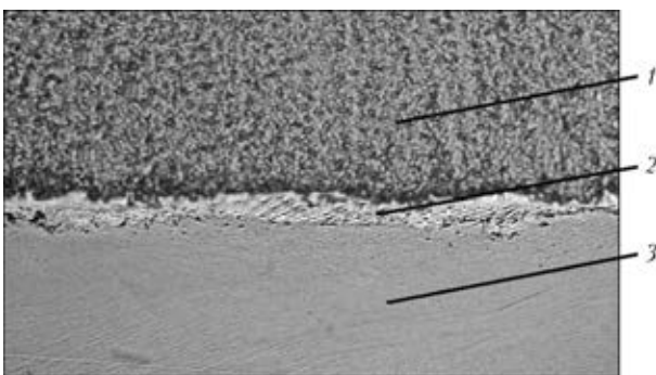
Рис. 3. Микроструктура ( \times 300 ) паяного соединения АТР + сталь до испытания бурового долота: 1 — твердый сплав VK8; 2 — паяный шов; 3 — сталь 30X
