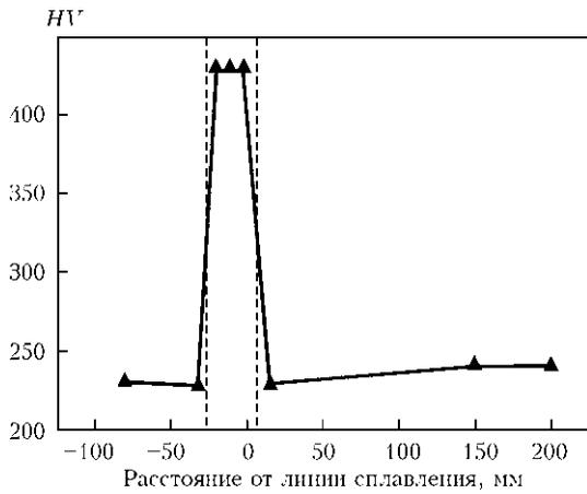
Рис. 2. Распределение микротвердости при наличии мартенситной прослойки
