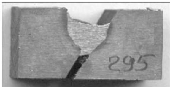
Рис. 6. Макрошлиф технологической пробы Теккен
