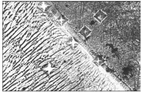
Рис. 4. Параллельная граница с прослойкой низкой твердости (x650)
