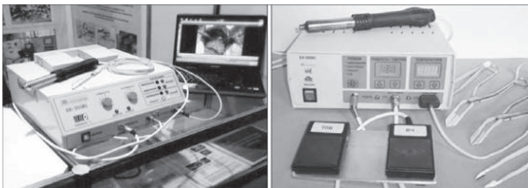
Рис. 17. Многофункциональные аппараты для высокочастотной сварки и КИ-обработки живых тканей на базе ЕК-300М1
