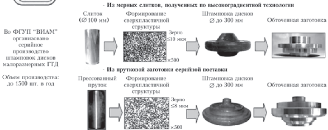
Рис. 8. Изотермическая штамповка жаропрочных дисковых сплавов на воздухе для малоразмерных ГТД
