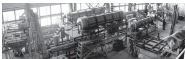
Рис. 2. Технологическая линия для производства агломерированных флюсов
