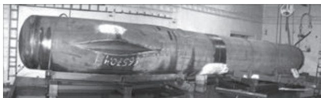
Рис. 4. Стенд для ресурсных испытаний элементов труб длиной до 6 м
