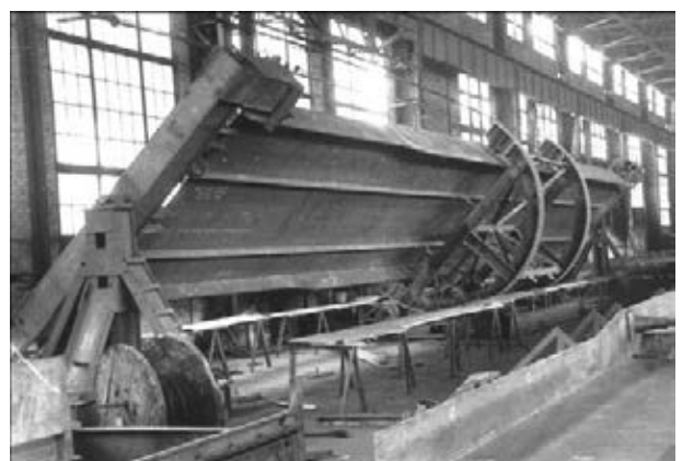
Рис. 4. Длинная балка в кантователе
