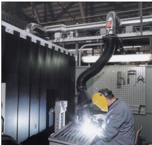
ный фильтровентиляционный агрегат **FILTOO**, который эффективен для удаления сварочного дыма, пыли и дыма от резки, работы лазера, при шлифовке и пр. Он имеет четырехступенчатую систему фильтрации, включая фильтр с активированным углём.
