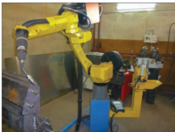
Рис. 1. Общий вид роботизированного комплекса для сварки элементов рамы автомобиля
