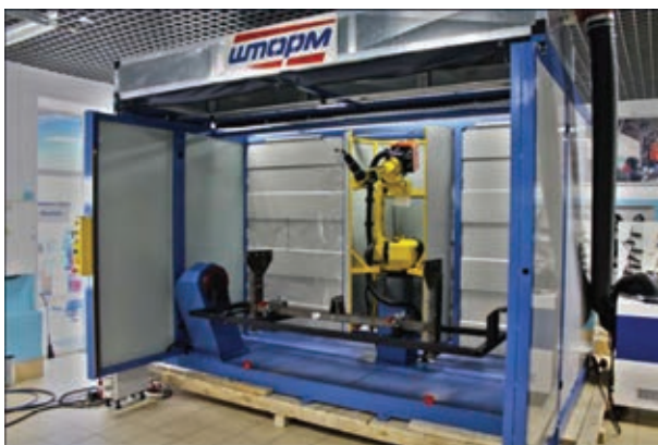
Рис. 4. Комплекс для сварки изделия «Стойка»
