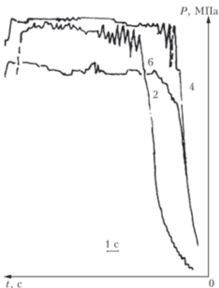
Рис. 4. Сравнение экструзионных кривых P_0 = f(t) обмазки Т-9, полученных с помощью капиллярного вискозиметра. Цифрами указаны диаметры насадок в миллиметрах
