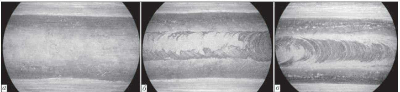
Рис. 5. Фрагменты поверхности швов ( \times 50 ), выполненных проволокой Sv-06X18N10 при испытаниях с использованием метода PVR-test на скорости принудительного деформирования: а — 2; б — 8; в — 12 мм/мин
