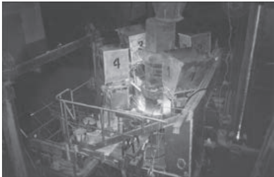
Рис. 7. Наплавка вала стана 2000 с использованием четырех вибродозаторов с бункерами для дроби массой 500 кг каждый
