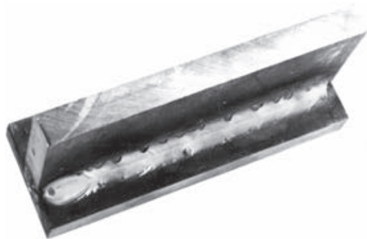
Рис. 2. Внешний вид углового шва, выполненного в смеси Ar + 20 % CO 2 проволокой Св-08Г2С диаметром 1,2 мм при I св = 260 А, U д = 28 В
