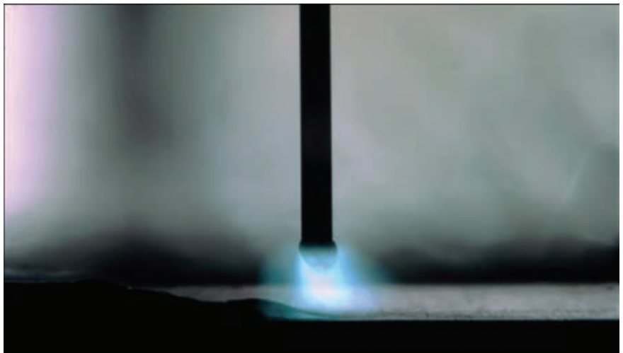
Прецизионный капельный перенос металла при режиме LSC обеспечивает невиданную ранее стабильность дугового процесса
