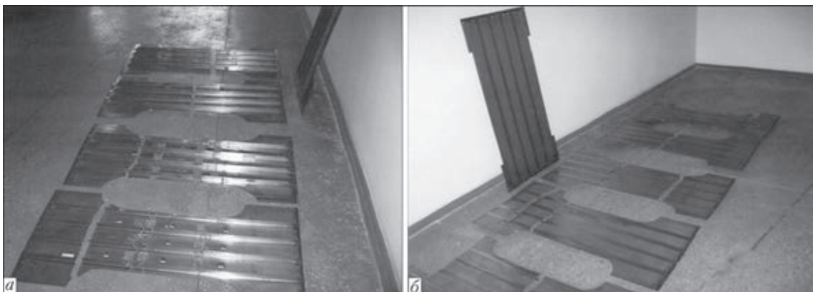
Рис. 11. Сварные стрингерные панели из сплава ВТ20 после испытаний на усталость, изготовленные способами ТИГ-Ф (а) и ТИГ-П (б)
