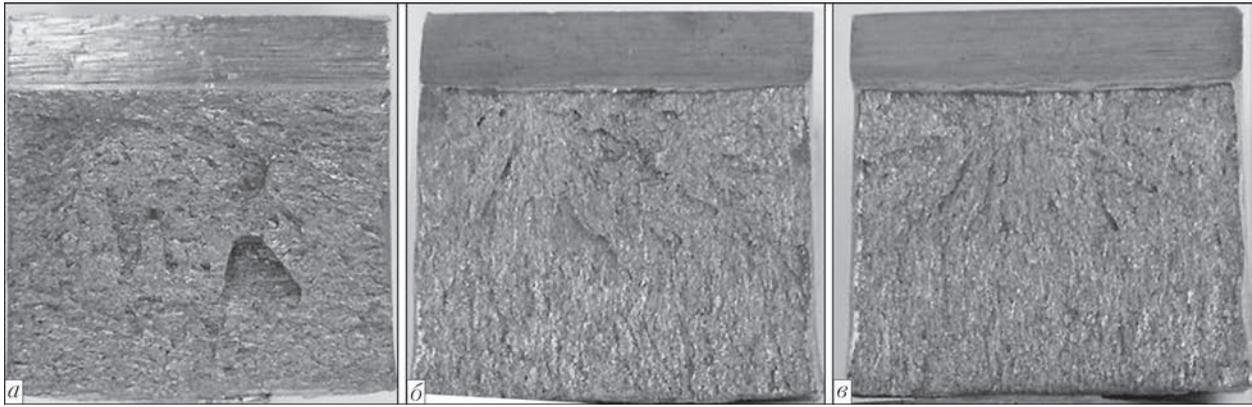
Рис. 9. Поверхность излома ударных образцов Шарпи при надрезе по центральной линии прокатки: а —  $KCV = 9,8$  Дж/см<sup>2</sup>; б — 22,2; в — 30,8
