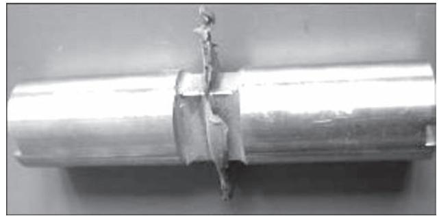
Рис. 3. Сварное соединение титанового сплава при ЛСТ
