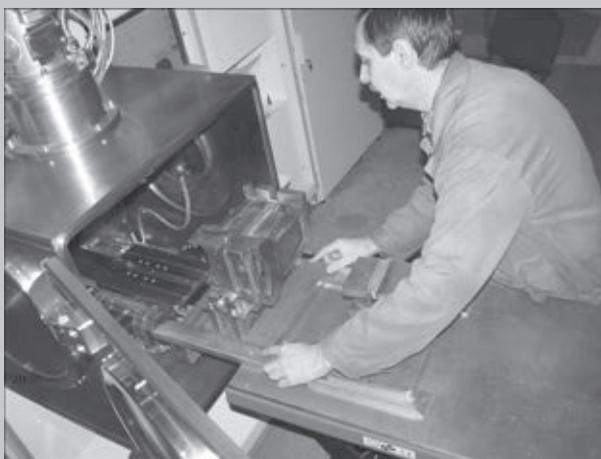
Ранее для электронно-лучевой сварки этих пакетов использовали установки с вакуумными камерами большого объема, где размещались многопозиционные поворотные столы со сварочной оснасткой для монтажа подлежащих сварке пакетов рабочих лопаток. Но высокая производительность такой установки не может быть востребована в условиях невысокой загрузки турбинного производства. Кроме того, стоимость самой установки и затраты на ее обслуживание достаточно высоки.
