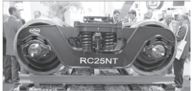
Рис. 8. Общий вид сварной конструкции тележки RC25NT
