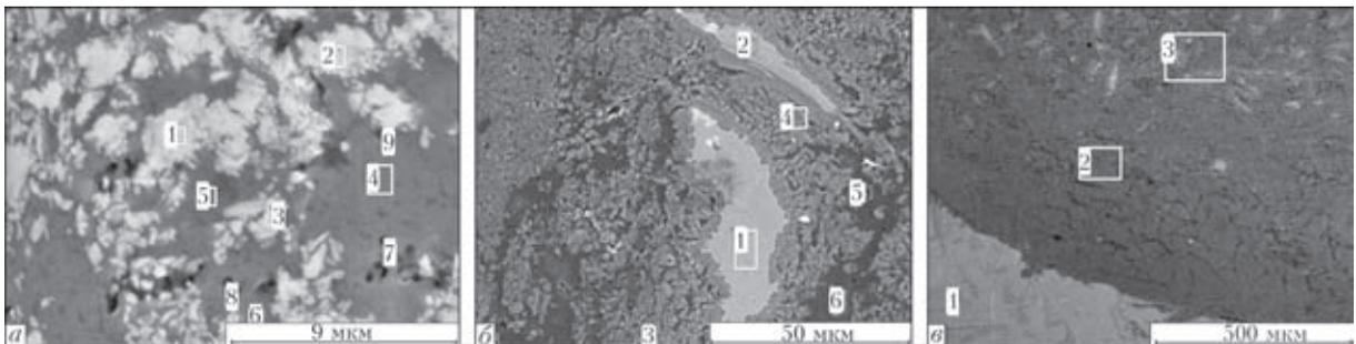
Рис. 14. Микроструктура верхней (*а*), средней (*б*) и нижней (*в*) части ядра соединений Al–Fe, полученных СТП, снятая в отраженных электронах
