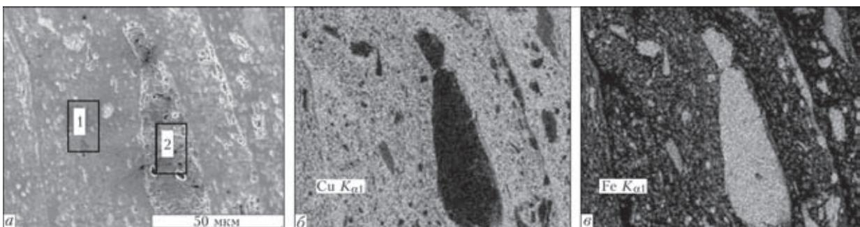
Рис. 11. Зона контакта Cu–сталь, снятая во вторичных электронах (*a*) и в характеристическом излучении меди (*б*) и железа (*в*)
