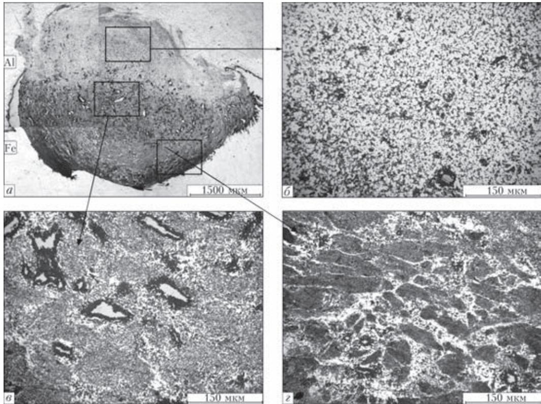
Рис. 13. Микроструктура поперечного сечения биметаллического соединения Fe–Al, полученного СТП: *а* — общий вид; *б* — верхняя; *в* — средняя; *г* — нижняя части ядра
