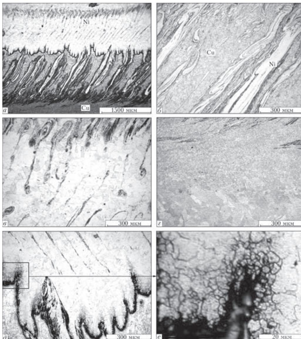
Рис. 4. Микроструктура продольного сечения сварного соединения Ni–Cu, полученного СТП: *a, б* — зона перемешивания никеля с медью; *в, г* — зона термомеханического влияния соответственно в никеле и меди; *д, е* — зона взаимодиффузии меди в никеле
