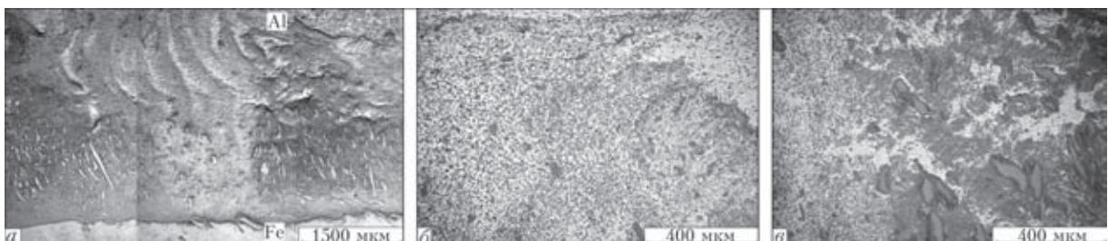
Рис. 15. Микроструктура продольного сечения сварного соединения Al–Fe, полученного СТП: *а* — общий вид; *б* — верхний; *в* — средний участок ядра
