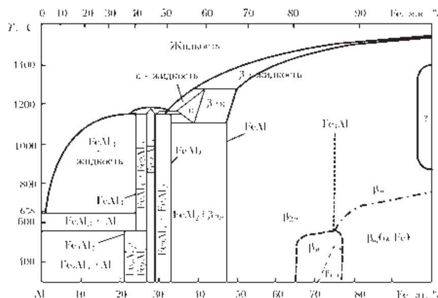
Рис. 12. Диаграмма состояния системы Fe–Al [19]
