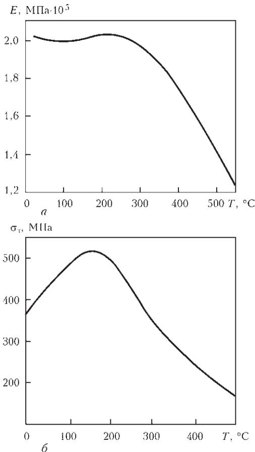
Рис. 2. Зависимость модуля упругости (а) и предела текучести (б) углеродистой стали от температуры
