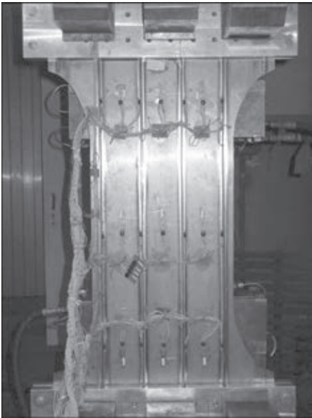
Рис. 12. Панель с наклеенными тензодатчиками, установленная в захватах машины для испытаний на усталость
