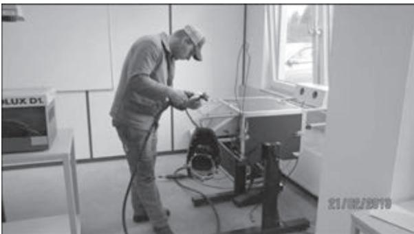
Рис. 2. Виртуальная система VWTS
