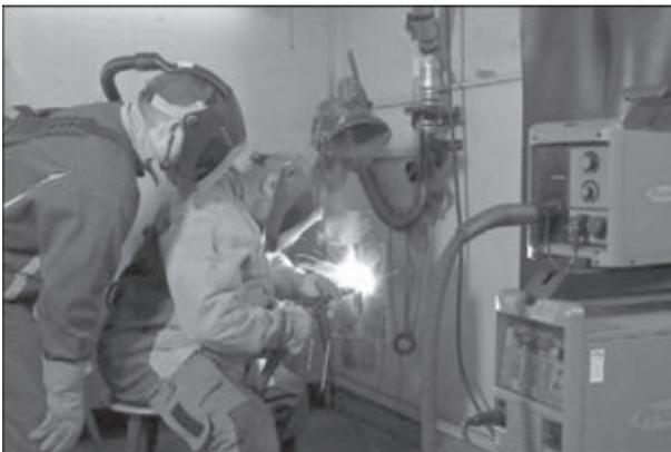
Рис. 4. Сварщик в процессе обучения в типовой сварочной кабине
