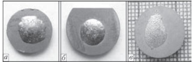
Рис. 3. Растекание при  $T_{\text{п}} = 1200$  °С опытного Ni–Cr–Zr припоя по Ni–Al ( $\tau = 5$  мин) (а) и Ni–Al–Mo–Co–W ( $\tau = 15$  мин) подложке (б) и промышленного припоя ВПр27 по Ni–Al–Mo–Co–W подложке ( $\tau = 15$  мин) (в)
