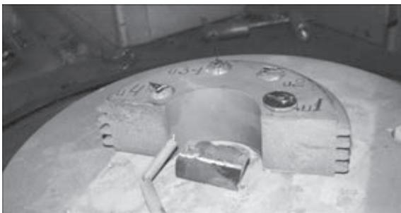
Рис. 2. Внешний вид образцов, подготовленных для пайки
