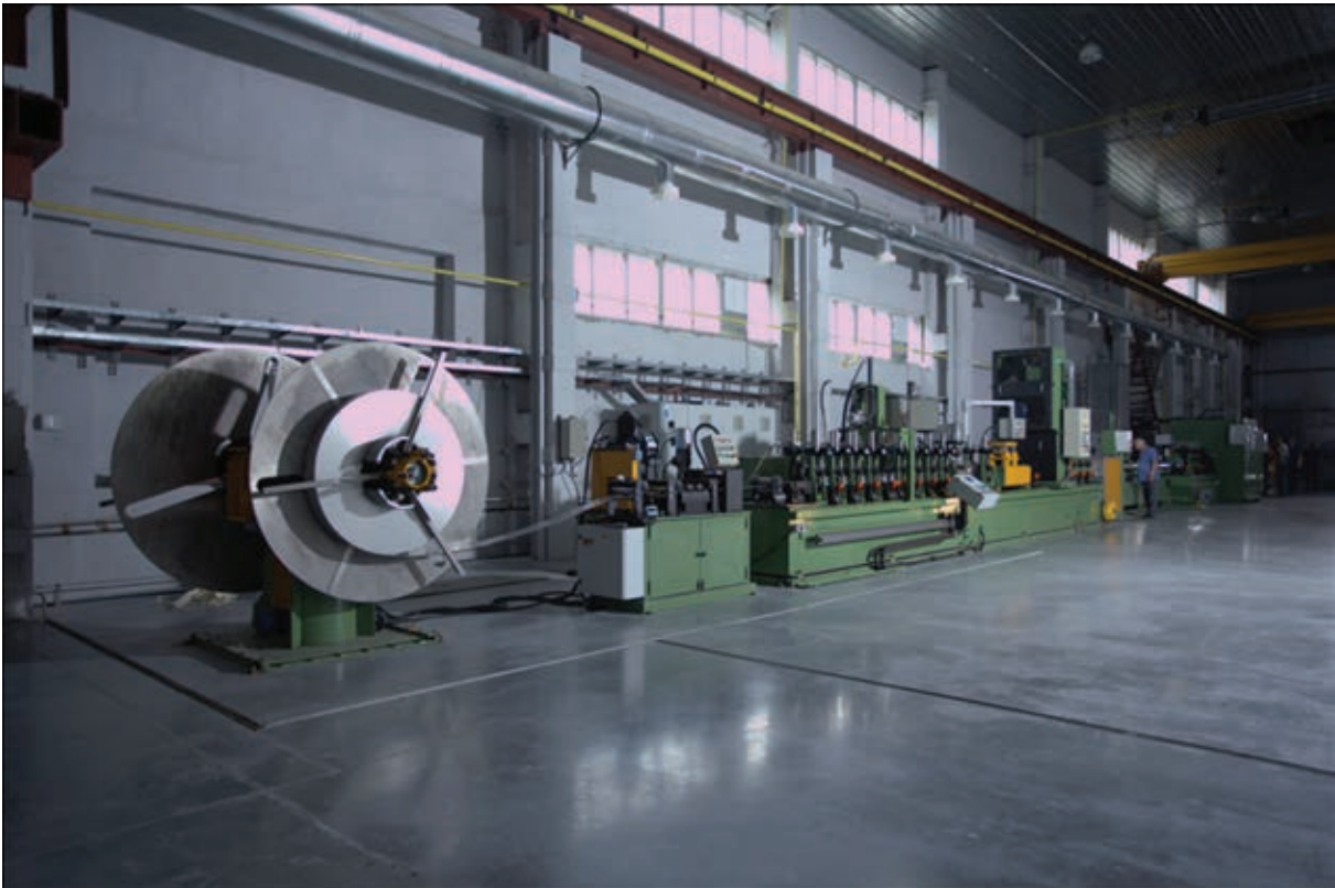
Рис. 1. Внешний вид трубоэлектросварочной линии (стан 10-60) в цехе по производству труб
