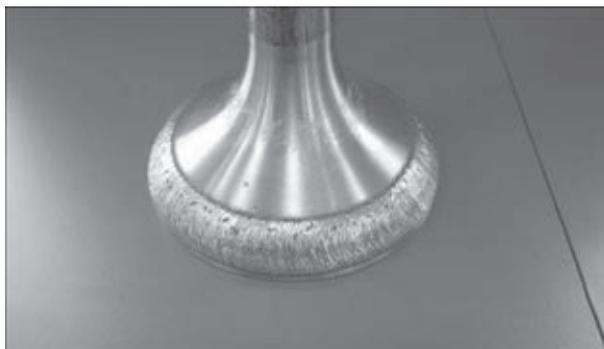
Рис. 8. Наплавка вентиля сплавом Stelloy 21-G
