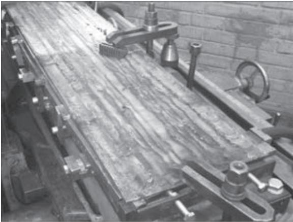
Рис. 8. Нанесенный на плите МНЛЗ слой меди (5 мм) методом СТП без водяного охлаждения
