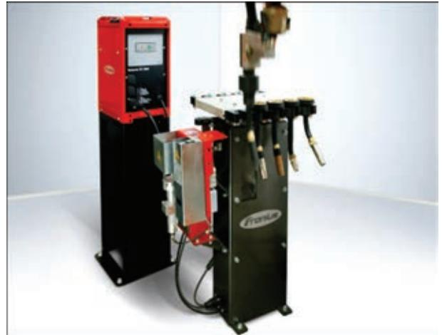
Robacta TX — автономная система для смены корпуса горелки от Fronius
