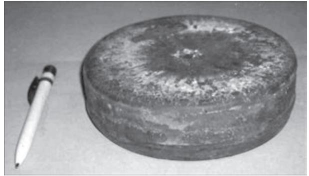
Рис. 3. Внешний вид наплавленной таблетками заготовки
