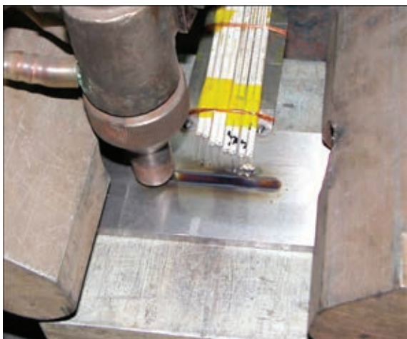
Рис. 1. Общий вид образца со швом и термопарами после сварки
