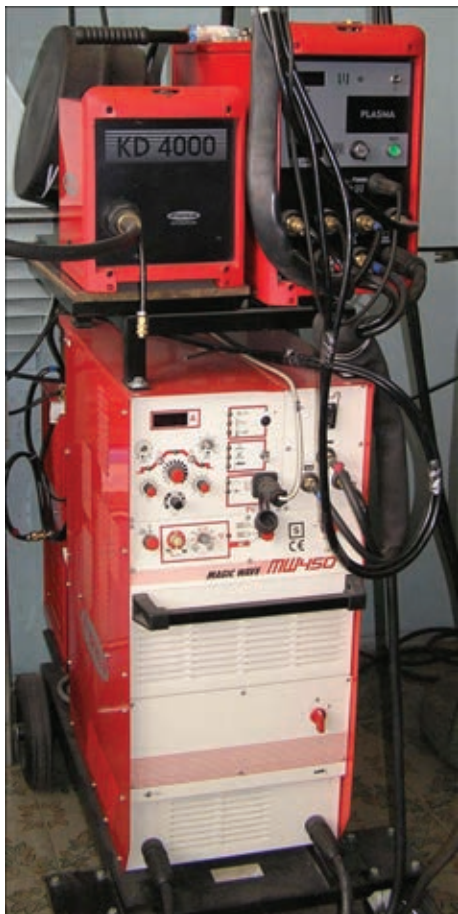
Рис. 7. Оборудование фирмы «Fronius» для плазменно-дуговой сварки алюминиевых сплавов разнополярным асимметричным током
