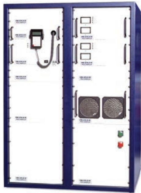
Рис. 5. Внешний вид источника питания LTP 400–VP (фирма «Liburdi») для плазменно-дуговой сварки по процессу VPPA [18]
