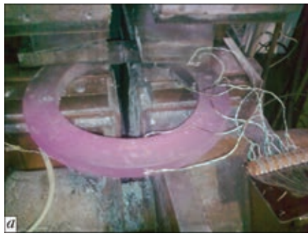
Рис. 1. Заготовка кольца в зажимных устройствах сварочной машины К-724 (а) и схема расположения точек (1–5) контроля температур (б)
