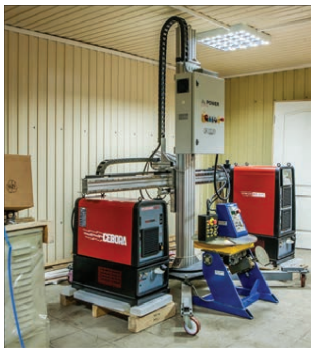
Рис. 16. Внешний вид универсального комплекса оборудования для плазменно-дуговой, комбинированной и гибридной сварки в разных пространственных положениях PLAZER PW-HYBRID TC
