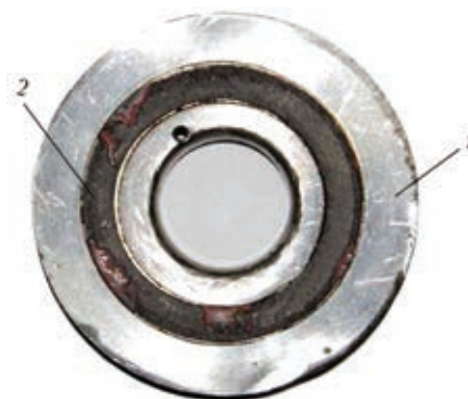
Рис. 1. Поверхность разрушения соединения металла (1) с графитом (2)
