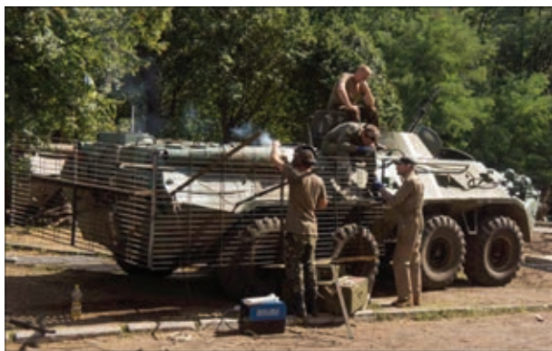
Монтаж противокумулятивных экранов сотрудниками кафедры на БТР-80 ВС Украины в зоне АТО
