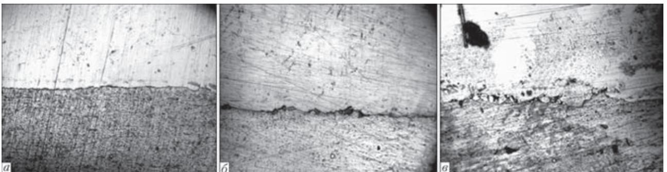
Рис. 3. Микроструктура ( $\times 200$ ) соединения медь–алюминий. а — в исходном после сварки и протяжки состоянии; б — после термообработки 180 °С, выдержка 30 мин; в — после термообработки 350 °С, выдержка 60 мин
