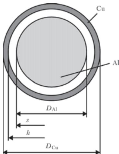
Рис. 7. Параметры коаксиальной заготовки под сварку взрывом
