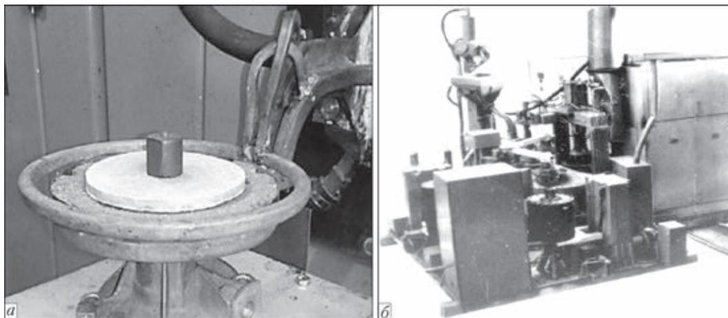
Рис. 6. Узел наплавки (*а*) и промышленная автоматическая поточная линия для наплавки ножей-ботворезов (*б*)
