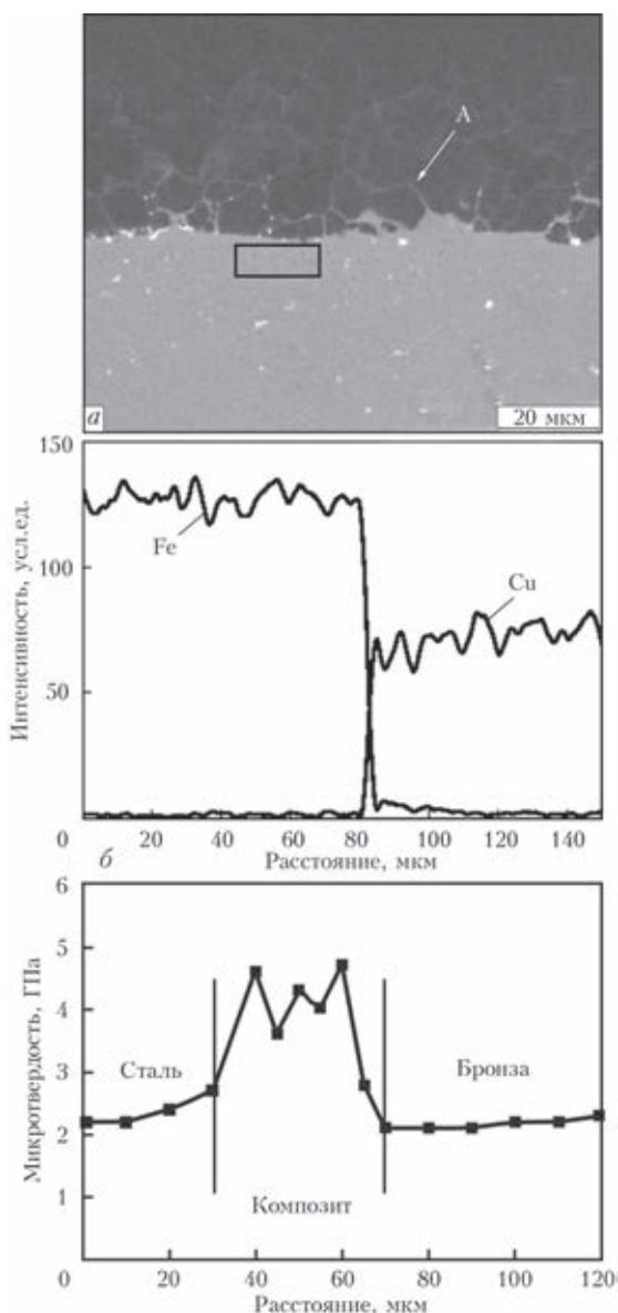
Рис. 5. Микроструктура сварного соединения сталь/бронза, полученного диффузионной сваркой с использованием промежуточной прослойки пористой меди (пористость 30 % об., толщина 30 мкм) на режиме:  $T_{св} = 700 \text{ }^\circ\text{C}$ ,  $t_{св} = 20 \text{ мин}$  (а), распределение основных элементов (б) и микротвердости (в) в зоне соединения
