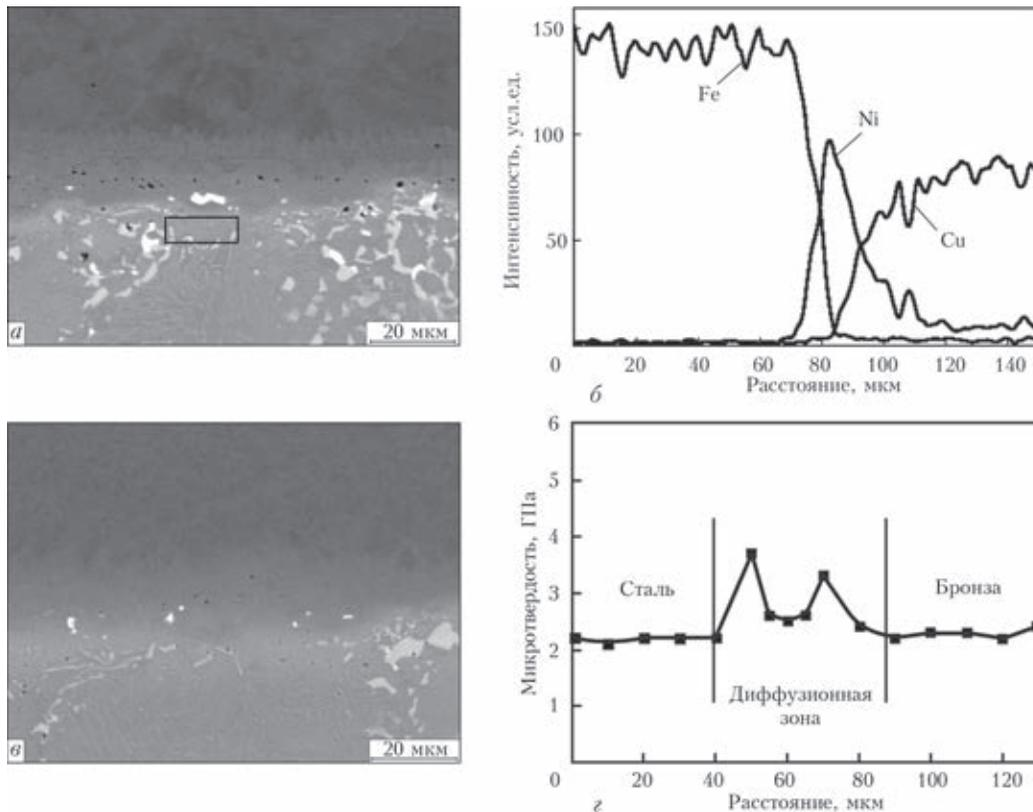
Рис. 4. Микроструктура сварного соединения сталь/бронза, полученного диффузионной сваркой с использованием промежуточной прослойки пористого никеля на режиме:  $T_{св} = 700\text{ }^{\circ}\text{C}$ ,  $t_{св} = 20\text{ мин}$ : а — пористость 25 % об., толщина 20 мкм и соответствующее распределение основных элементов в области стыка (б); в — пористость 10 % об., толщина 20 мкм и распределение микротвердости в зоне соединения (д)
