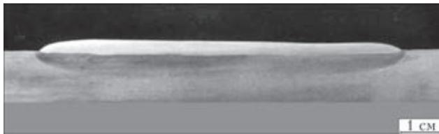
Рис. 9. Макрошлиф поперечного сечения наплавленного валика ( $\alpha = 120^\circ$ )
