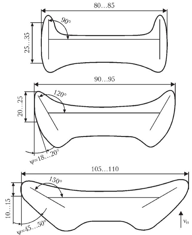
Рис. 6. Моделирование формы и размеров сварочной ванны (границ изотермы  $T_{пл}$ )
