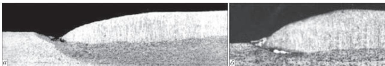
Рис. 1. Дефекты формирования валика при наплавке ленточным электродом: а — подрез; б — краевой непровар и шлаковое включение
