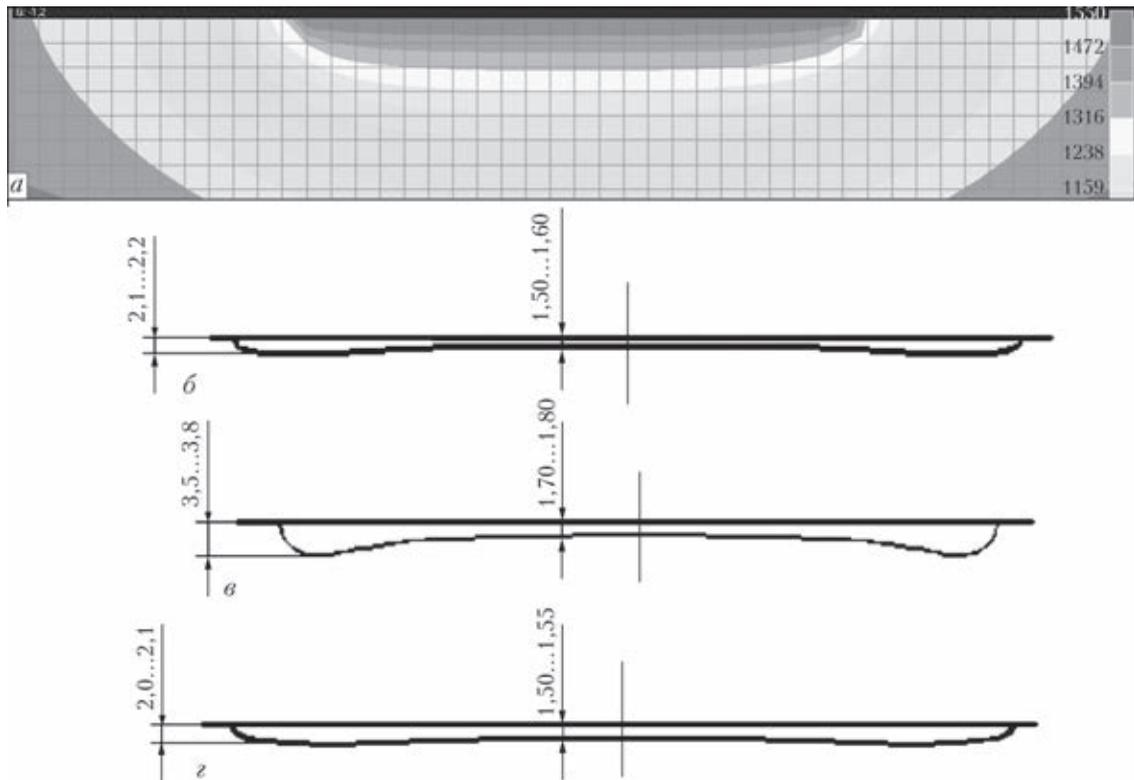
Рис. 8. Модель теплового поля (а) и границы изотермы  $T_{пл}$  (б–г) в плоскости, перпендикулярной наплавляемой поверхности:  $\alpha = 120^\circ$  (а, б);  $90^\circ$  (в);  $150^\circ$  (г)
