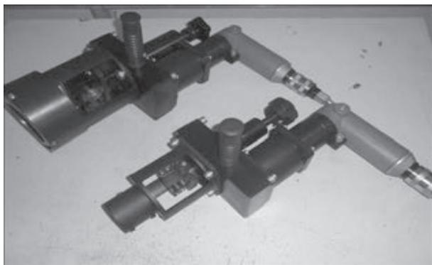
Рис. 5. Общий вид опытных образцов торцевателей ТРЦ 38 УЗ.1 и ТРЦ 76 УЗ.1 (слева)
