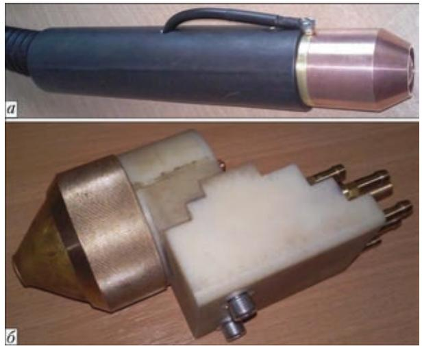
Рис. 17. Плазмотроны разработки ИЭС им. Е.О. Патона для плазменно-дуговой сварки неплавящимся (а) и гибридной плазменно-дуговой сварки плавящимся (б) электродами
