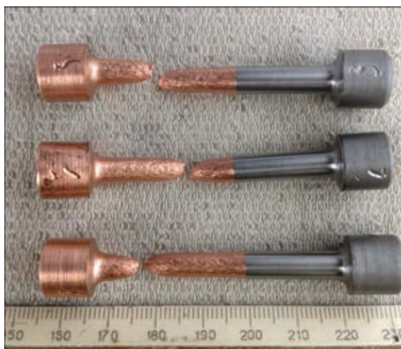
Рис. 4. Образцы после испытаний на растяжение
