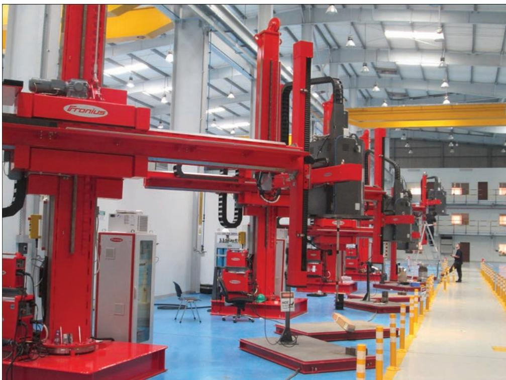
Рис. 2. Системы наплавки GTAW с непрерывным вращением горелки ETR® внутренних или внешних поверхностей изделий
