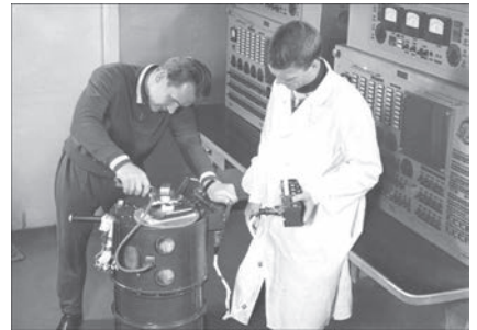
Установка «Вулкан» для сварки и резки в космосе (В. Н. Кубасов и А. А. Загребельный, г. Киев, 1968 г.)
