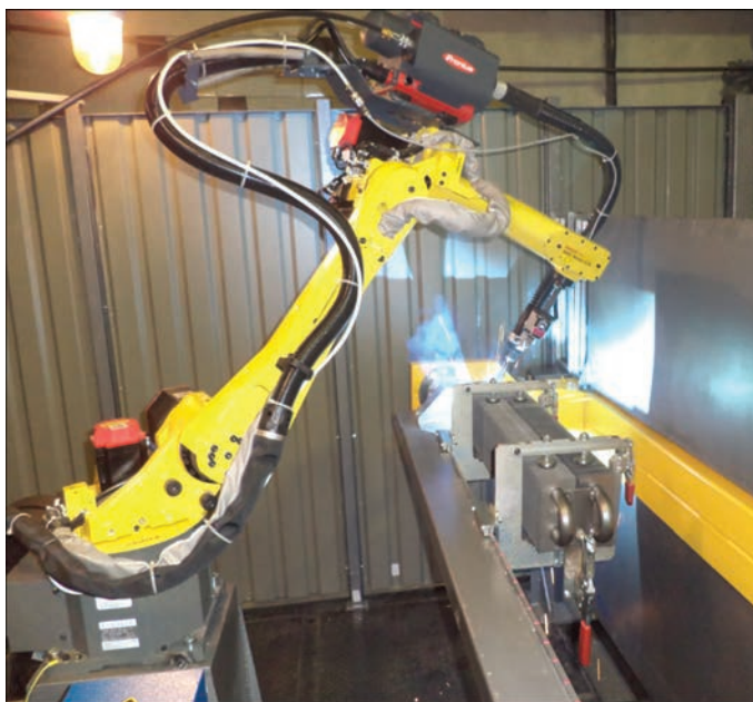
Рис. 4. Установка АС354 для автоматической восстановительной МИГ/МАГ-наплавки роторов двигателей и насосов
