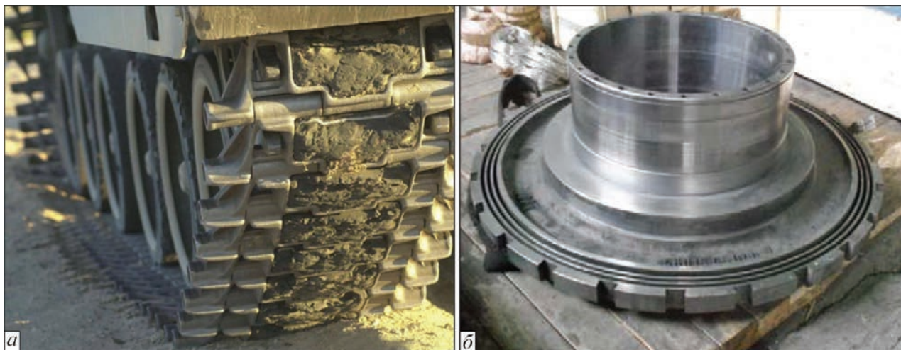
Примеры применения износостойких МСА-проволок: а — наплавка цевок трака гусениц; б — нанесение покрытия толщиной 5 мм на поверхность опоры диаметром 500 мм
