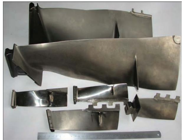
Рис. 7. Примеры реализации разработанной ремонтной технологии для различных типоразмеров лопаток (большие — вентиляторного тракта, меньшие — КНД), а также формы и протяженности дефектов кромки пера
