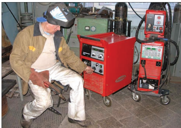
Рис. 2. Использование инверторных источников питания дуги с соответствующими подающими механизмами для сварки порошковыми проволоками
