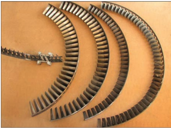
Рис. 14. Отремонтированные полукольца направляющих аппаратов различных ступеней статора КВД
