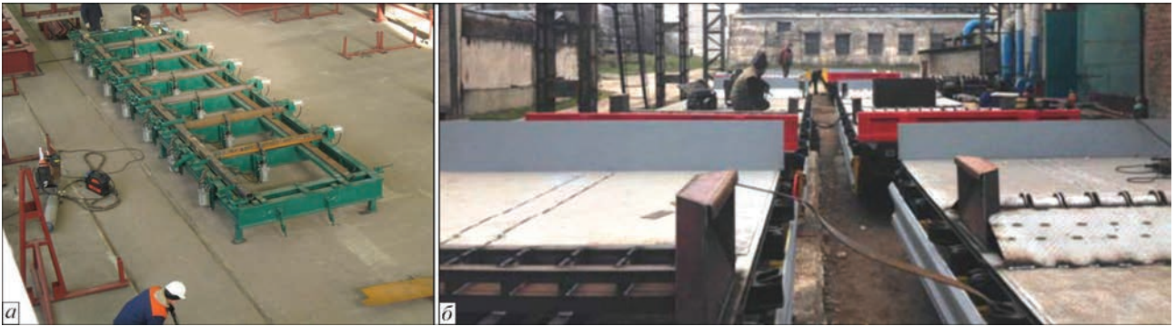
Рис. 3. Типичные объекты применения сварки порошковыми проволоками: а — сборка-сварка каркаса боковой стенки грузовых вагонов (ООО «Югпромтехмонтаж», г. Херсон) [15]; б — сварка металлоконструкций платформы для перевозки слябов, рельсов (ПАО «Верхнеднепровский машиностроительный завод»)
