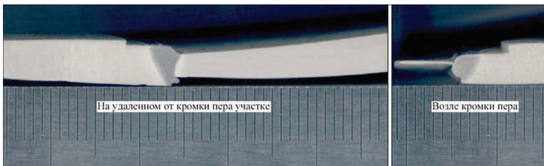
Рис. 2. Макрошлифы ремонтного ЭЛС-соединения «вварыша» и пера лопатки
