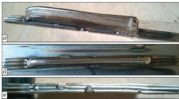
Рис. 6. Образец, полученный с использованием проволоки в качестве подложки для осаждения: a — вид сбоку; b — сверху; c — снизу
