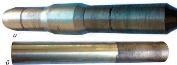
Рис. 6. Довгомірний трубчатий елемент, виготовлений на стані ДУО-175-2: а — до прокатки; б — після прокатки та обробки
