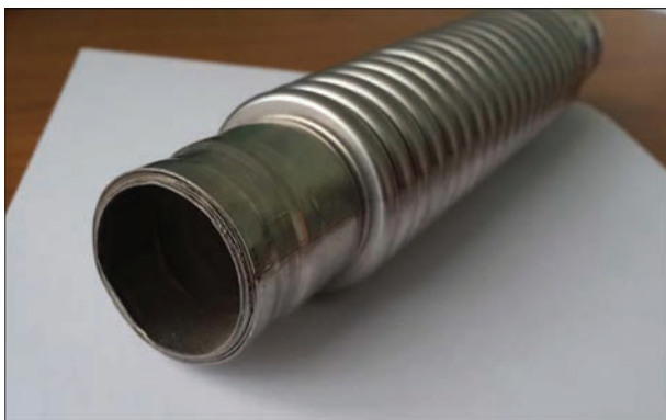
Рис. 3. Внешний вид заготовки многослойного сиффона после гидроформовки
