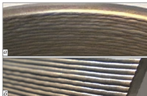
Рис. 8. Стенки, сформированные из проволоки диаметром 2 мм: a — нержавеющая сталь 304L, толщина слоя 0,6 мм; b — титановый сплав Ti-6Al-4V, толщина слоя 1,2 мм
