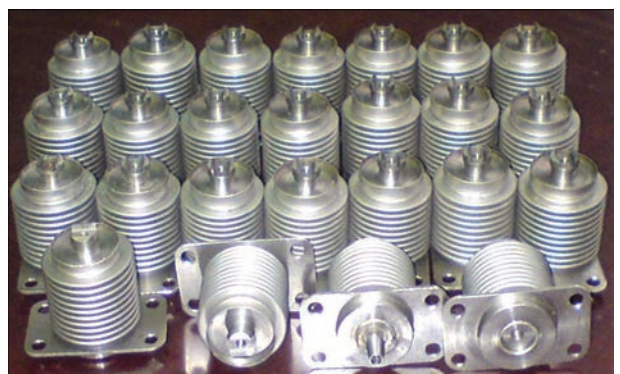
Рис. 6. Партия сильфонных компенсаторов, изготовленных с применением лазерной сварки
