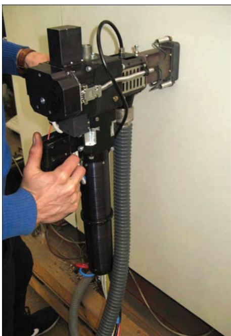
Рис. 8. Внешний вид разработанного инструмента для ручной лазерной сварки
