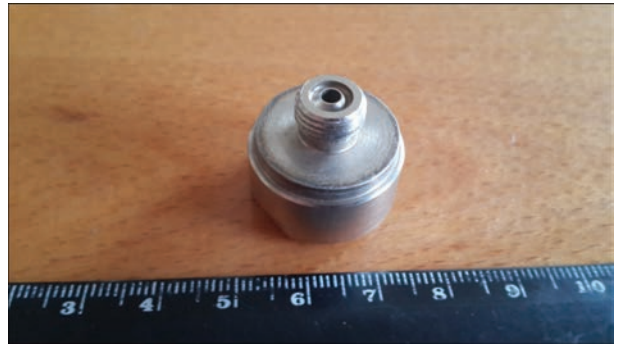
Рис. 12. Корпус датчика из стали 08Х18Н10Т, сваренный лазерным излучением
