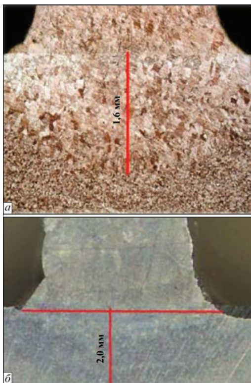
Рис. 5. Макрошлиф металла зоны термического влияния при осаждении проволоки: а — из титана BT1-0 диаметром 1,6 мм на плиту из титана BT1-0; б — из титанового сплава Ti-6Al-4V диаметром 3,0 мм на плиту из сплава Ti-6Al-4V
