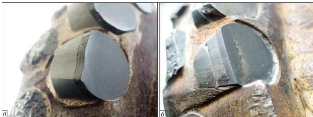
Рис. 1. Внешний вид изношенных резцов лопасти стального бурового долота (×3): а — АТФ «Syndrill» после проходки 1000 м; б — составной резец АТФ ИСМ НАНУ после проходки 250 м
