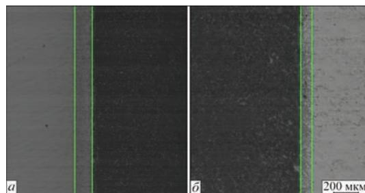
Рис. 6. Микроструктура АТП с маркером ширины переходной зоны, мкм: а — «Syndrill», 140,6; б — АТП (ИСМ НАНУ), 90,82
