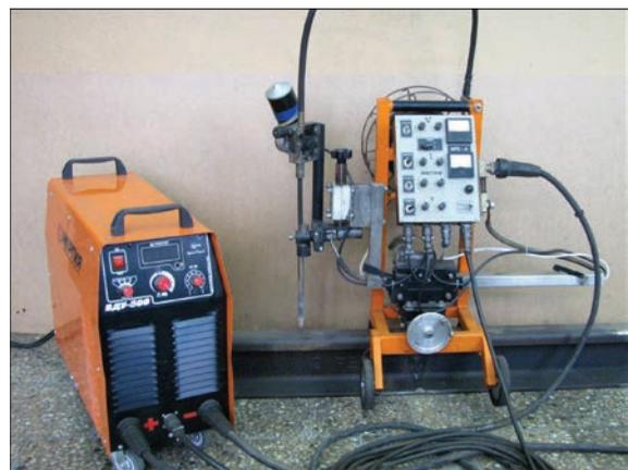
Рис. 1. Комплект опытного оборудования для автоматической дуговой наплавки рельсов порошковой проволокой
