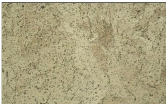
Рис. 3. Микроструктура ( $\times 500$ ) металла шва при легировании бором
