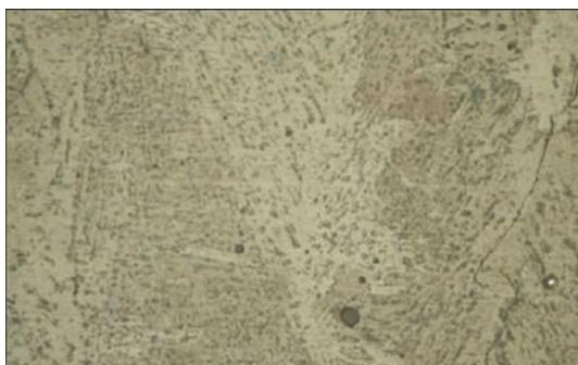
Рис. 4. Микроструктура ( $\times 500$ ) металла шва при легировании титаном
